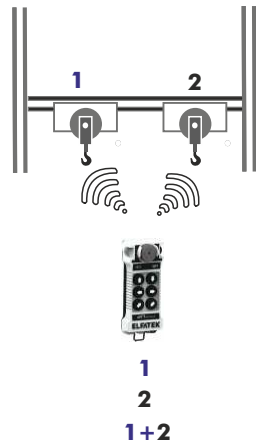
Betrieb von zwei Wagen auf einer Brücke, mit einer Fernbedienung
