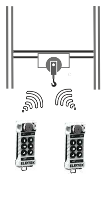
Fonctionnement d'une seule grue portique avec deux commandes différentes
