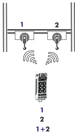
Fonctionnement deux chariots sur un seul pont avec une seule commande
